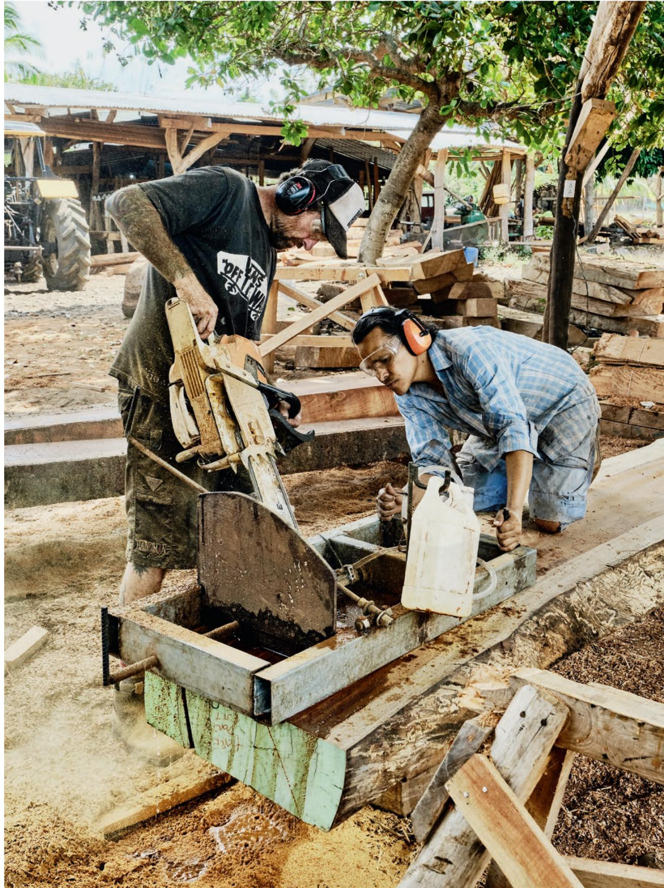
Eine Werft für Holzboote ist auch ein Sägewerk. Die Yardies, wie die Arbeiter genannt werden, behelfen sich beim Zusägen mit abenteuerlichen Konstruktionen für Wasserkühlung und Führung der Motorsägen
